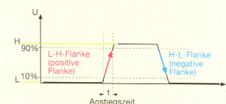
Bild 25: Der Aufbau eines Zähl-impulses. Wesentliche Elemente sind die H-L (L-H)-Übergänge, Flanken genannt und die Anstiegszeit, die die Flankensteilheit bestimmt.
