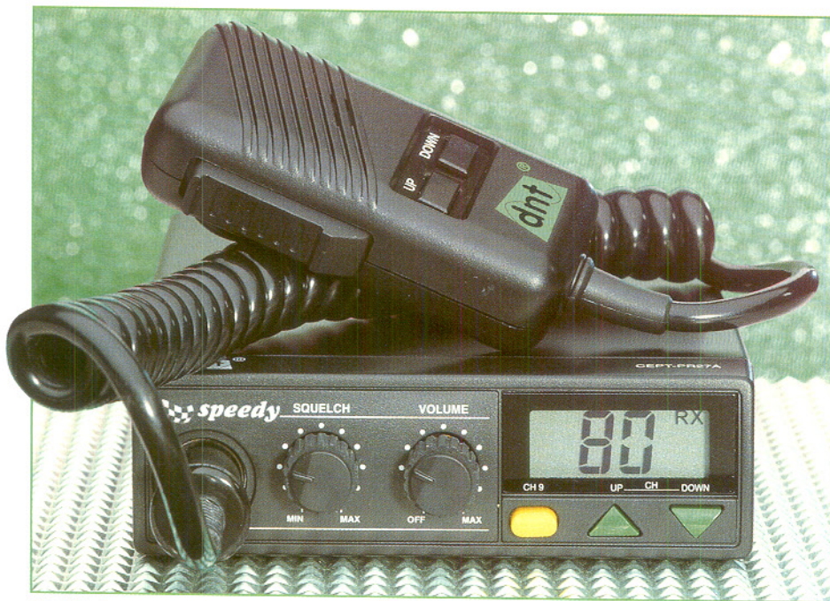
Bild 6: Der Größenvergleich zum Mikrofon zeigt es deutlich, auch mobile CB-Funkgeräte sind meist sehr kompakt ausgeführt und dazu deutlich einfacher zu bedienen als ein modernes Autoradio.
