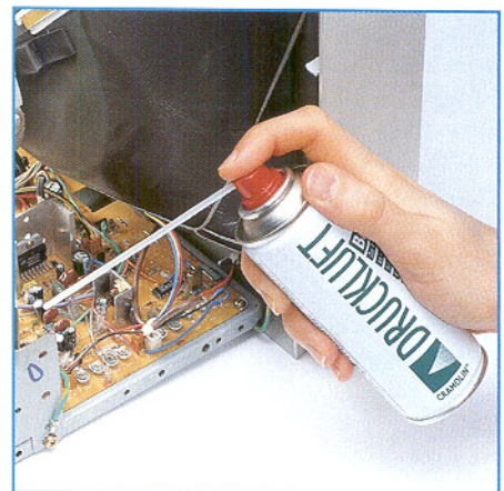
Bild 7: Druckluft ist das richtige Mittel, solch eine verstaubte Platine zu reinigen.
