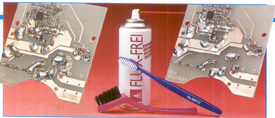
Bild 10: Der Leiterplattenreiniger sorgt für eine rückstandslose Entfernung von Lötmittrückständen.
